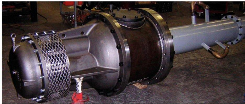
Abb. 5: Pumpe mit Tauchrohrkomponenten
