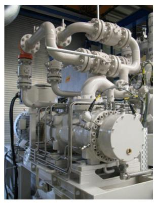
Bild 5: Multiphasenpumpen-Aggregat auf Multiphasenpumpen-Prüfstand
